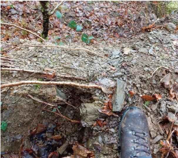
Interstrate de schiste bien visible au sein de l'ensemble calcaire de l'Isbelle qui compartimente ce massif rocheux et qui influence l'orientation et l'extension de sa karstification .
