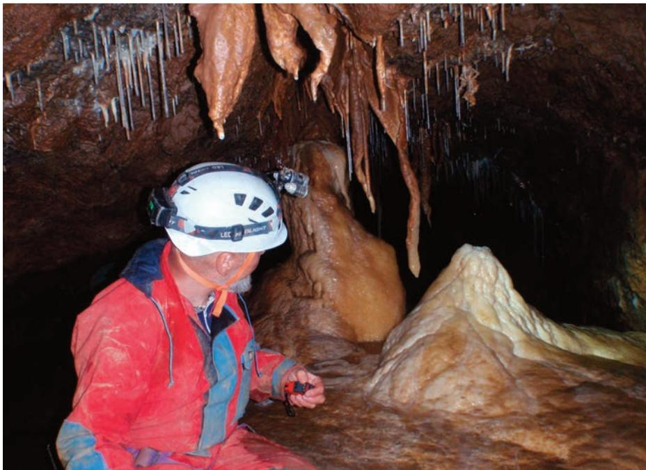
Photo. 2. Mesure des paramètres physico-chimiques dans un gour de la salle des Rhomboédres et estimation du volume d'eau (sur base de la dimension et de la profondeur de la vasque).
