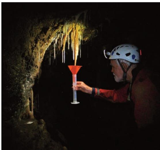
Photo. 1. Prélèvement de la percolation à la station N°9 (avec mesure du débit à l'aide d'une éprouvette graduée).
