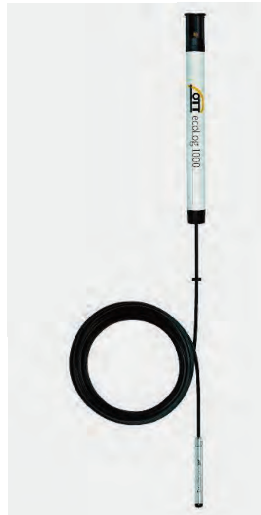
Fig. 4 : Une sonde de niveau automatique. "En bas" le capteur de pression, à immerger au fond du piézomètre ; "en haut" l'unité d'acquisition et le modem qui restent suspendus au niveau de la tête de protection de l'ouvrage.
