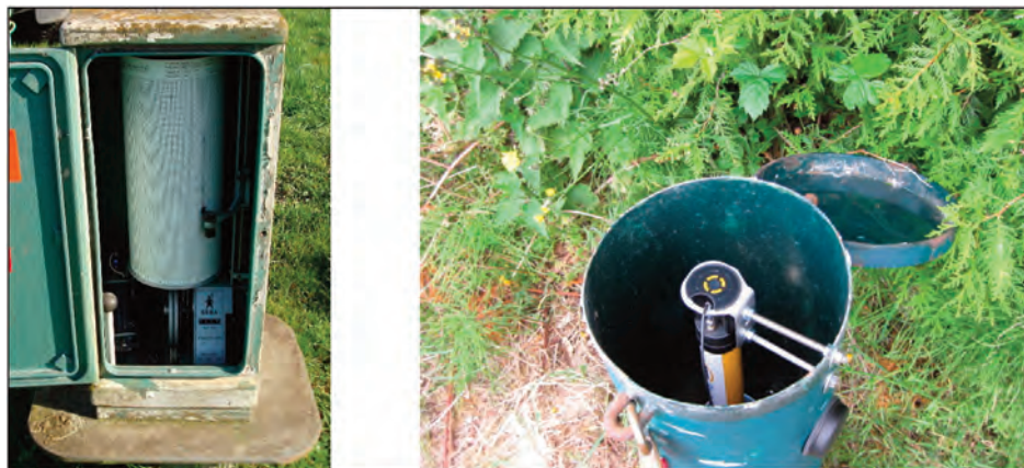
Fig. 6. Les piézomètres mesurés manuellement ou grâce à des limnigraphes (à gauche) ont été progressivement équipés d'une sonde automatique de pression avec télétransmission des données (à droite)
