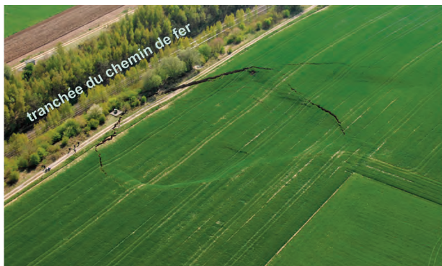
Fig. 11. À gauche, aperçu de l'affaissement en surface, s'étendant sur plus d'un Ha (photo Police fédérale, 2015). À droite: malgré son allure, cette remontée de fontis linéaire n'est pas une galerie mais bien le vide d'effondrement au-dessus de la galerie (« migration » verticale du vide initial). Le sommet des éboulis se trouve à 4 m au-dessus du sol de la galerie, au niveau de son toit (fontis linéaire sur faille, Cuesmes, photo SPW, SGW).
