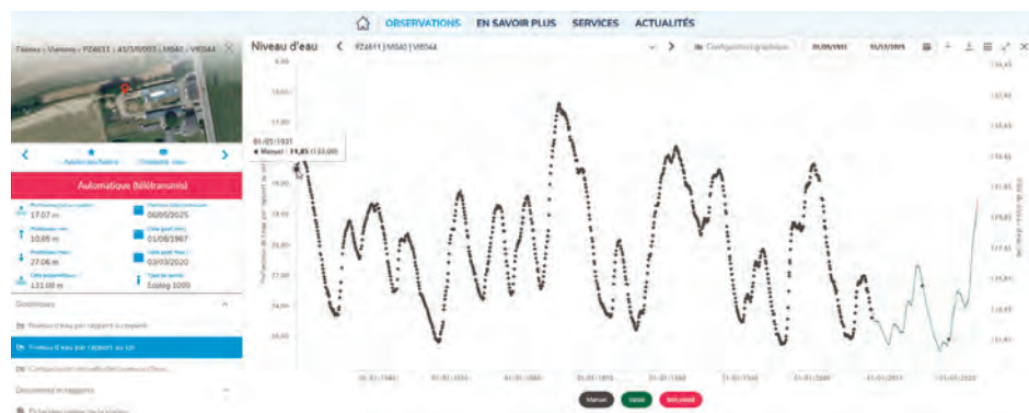
Fig. 5. Chronique piézométrique du piézomètre de Viemme (craies du bassin du Geer) de 1931 à 2025. En noir : mesures manuelles ou lectures limnigraphes. En vert : données automatisées.
