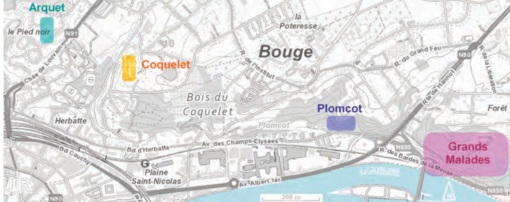
Fig. 14. Quelques anciennes carrières souterraines calcaires autour de Bouge, surveillées par le SPW vu leur possible instabilité.
