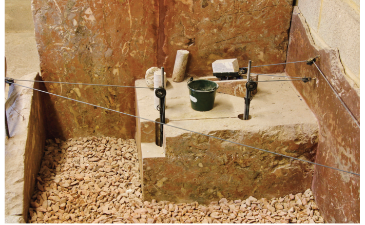
Fig04. Maquette du Musée illustrant la technique de découpe et d'extraction des blocs de marbre à l'aide d'un fil hélicoïdal.
