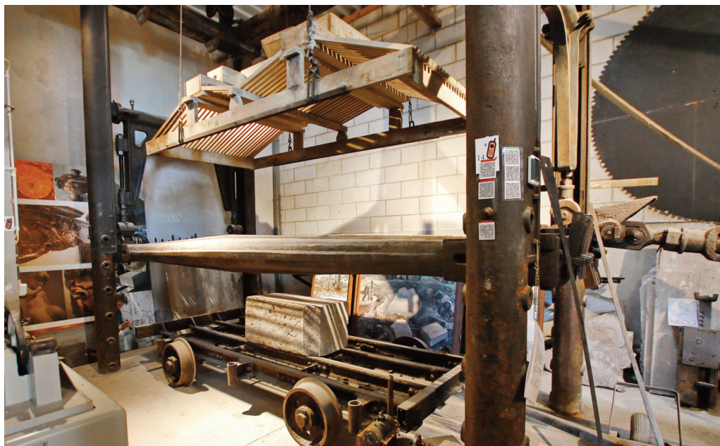
Fig 06. Armure à scier équipée d'une série de lames dont l'écartement était ajusté par l'ouvrier selon l'épaisseur des « tranches » requises.
