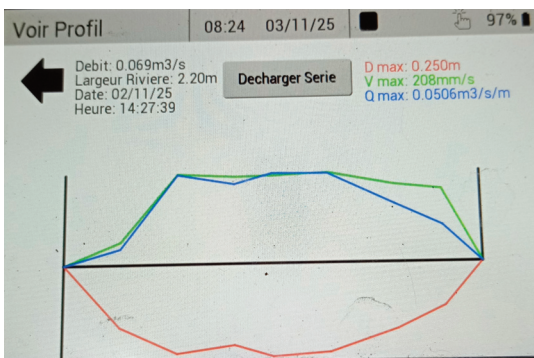
Fig. 11b. Relevé au courantomètre à l'aval du Sourd d'Aiwe. La ligne rouge matérialise le fond du cours d'eau alors que le tracé vert correspond à la vitesse enregistrée. C'est en multipliant la surface mouillée par la vitesse que le logiciel calcule le débit.
