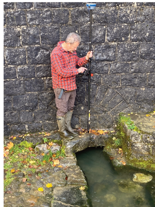
Fig. 6. La résurgence du Lavoir. Positionnement au GNSS et relevé précis des altitudes.
